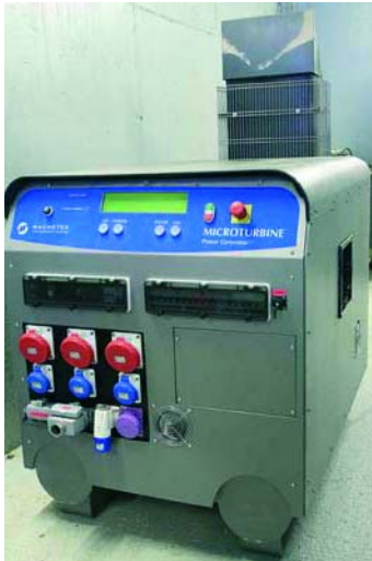
Figura 31. Microturbina Magnetek Cortesía de LABEIN-TECNALIA.
