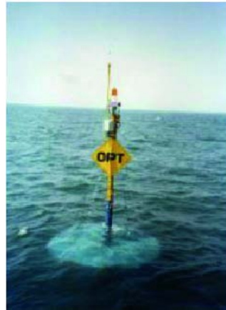
Figura 37. Sistema desarrollado por OPT (Ocean Power Technologies).
