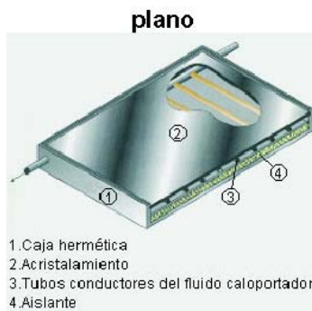
Figura 14. Esquema de captador plano.
