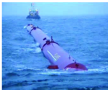
Figura 35. Pelamis. Sistema desarrollado por OPD (Ocean Power Delivery). Fuente: www.oceanpd.com .
